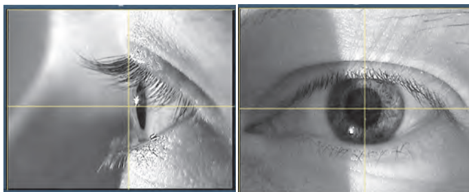
Рис. 7. Снимки с латеральной и фронтальной TV камеры системы TV позиционирования с наложенным виртуальным перекрестием
