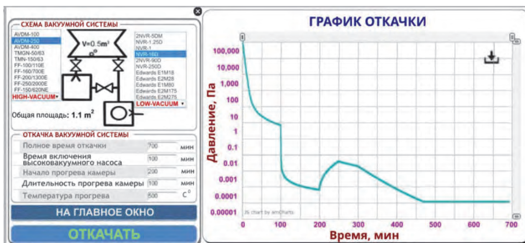
Рис. 4. Процесс откачки вакуумной системы в ВЛ «Вакуумная техника»
