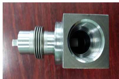
Рисунок 2. Элементы крепления датчика на трубопроводе
