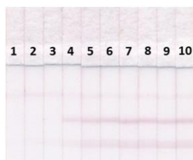
Рисунок 3. Вид тест-полосок после двойного ИХА ДК и МЦ в морской воде. Концентрации добавленных в воду ДК/МЦ: 1 – 667/3,3; 2 – 222/1,1; 3 – 74/0,37; 4 – 24,7/0,12; 5 – 8,2/0,04; 6 – 2,7/0,01; 7 – 0,91/4,57 × 10 -3 ; 8 – 0,30/1,52 × 10 -3 ; 9 – 0,10/5,1 × 10 -4 ; 0,03/1,7 × 10 -4 нг/мл.
